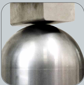
Rechteckiger Stempel mit halbkugelförmigem Amboss
